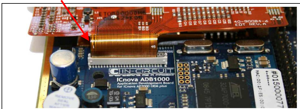
Abbildung 3: Display linksbündig einsetzen
