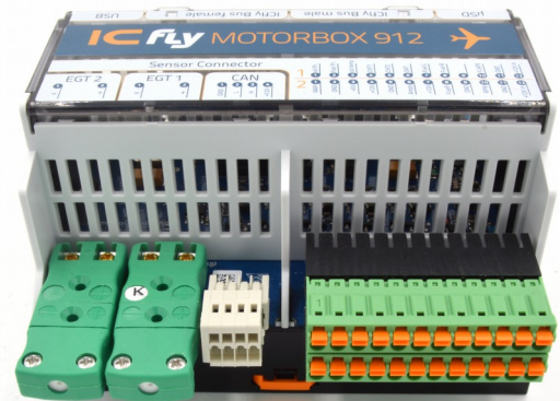
Ansicht Anschlüsse CAN Bus und Sensoren
