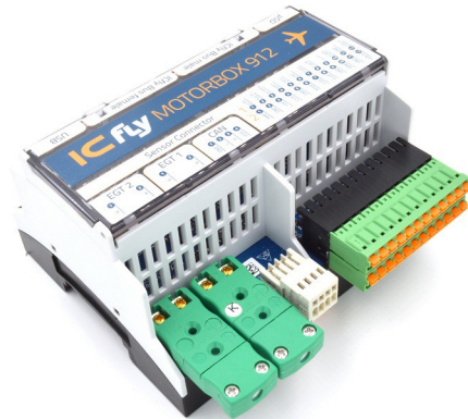
Ansicht Anschlüsse CAN Bus und Sensoren 45°
